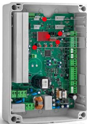
2 logements de **cartes enfichables** de commande et de sécurité via radio (bourellets de sécurité autocontrôlés, détecteur à boucle magnétique, décodeur pour sélecteur RFID)
